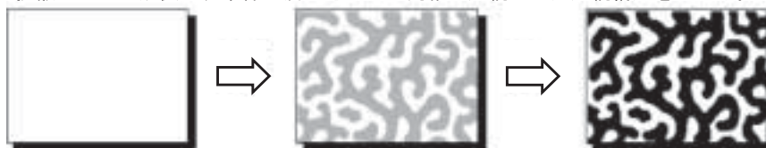
図2 核生成・成長およびスピノーダル分解による相領域(ドメイン)の形成過程
